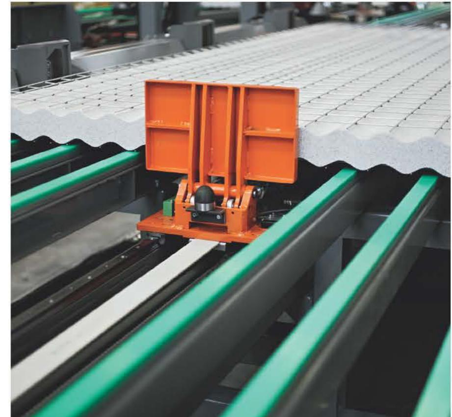
Nos machines produisent des panneaux sandwich qui se composent de plaques en polystyrène assemblées avec des treillis électro soudés en acier galvanisé.
