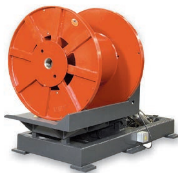
Roller tilter bringing the spooler from the horizontal to the vertical position. Bascualdor de carretes para llevar los carretes de la posición horizontal a la vertical. Basculeur des rochets pour porter les rochets de la position horizontale à la verticale. Vira fieiras para levá-los da posição horizontal àquela vertical.
