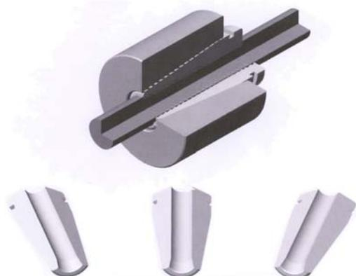
I morsetti reimpiegabili di tipo aperto sono i più utilizzati nella precompressione a cavi aderenti per la immediatezza d'impiego, economicità, facilità di ispezione visiva e manutenzione.
